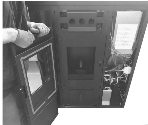
Fig. 17 - Rimuovere la cerniera
