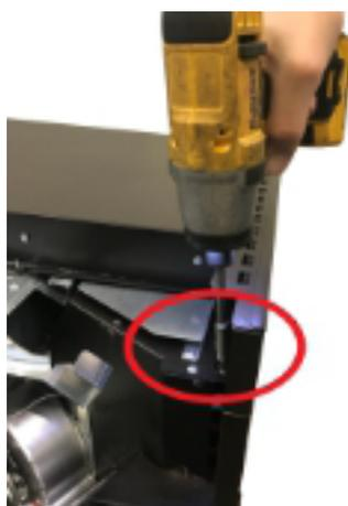
**Fig. 56 - Fijación delantera del cajón**
