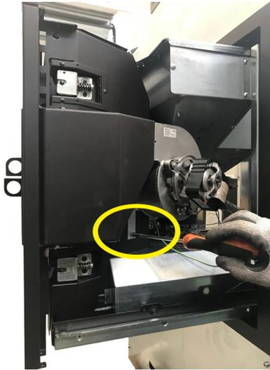
**Fig. 97 - Extraiga el ventilador**
