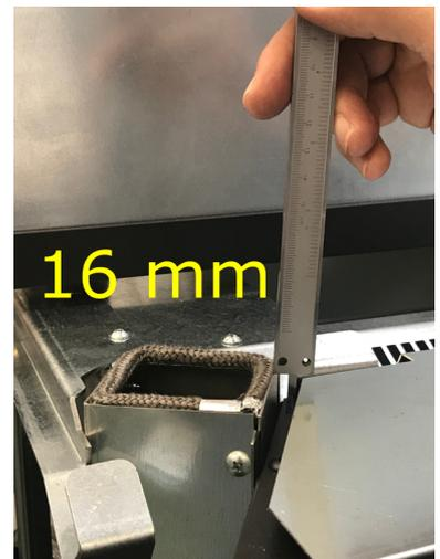
**Fig. 48 - Saliente del desviador del aire**
