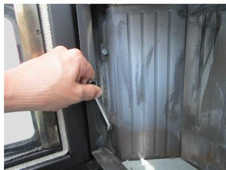
**Fig. 109 - Extracción de los tornillos**
