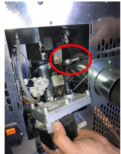
Fig. 92 - Extracción del motorreductor
