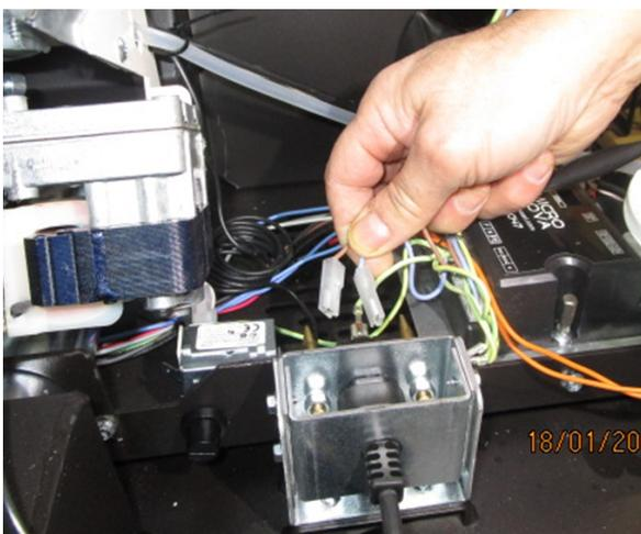
**Fig. 87 - Desconexión del terminal faston (azul - marrón)**
