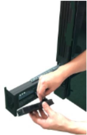
**Fig. 85 - Conecte la pantalla y vuelva a colocarla**
