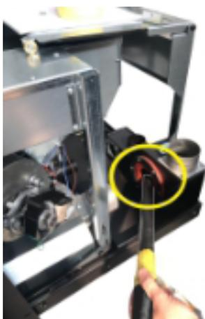
**Fig. 114 - Limpieza del canal de humo**
