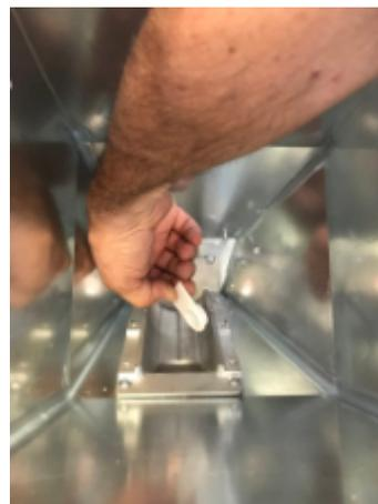
**Fig. 94 - Extracción del cojinete**
