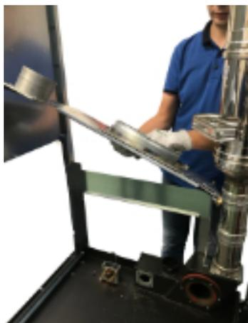
*Fig. 59 - Extracción de la tapa*
