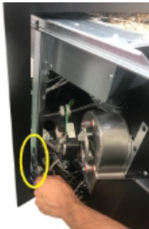
**Fig. 23 - Afloje los tornillos**
