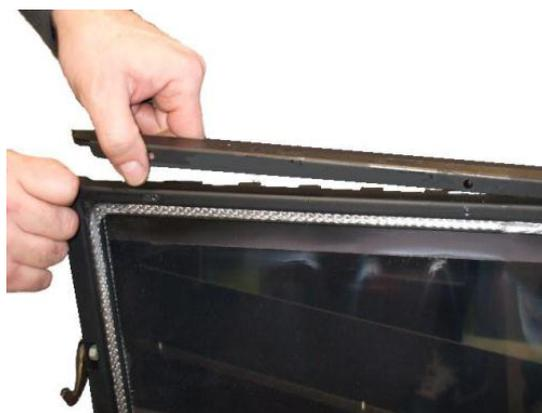
**Fig. 116 - Extracción de los perfiles de la puerta**
