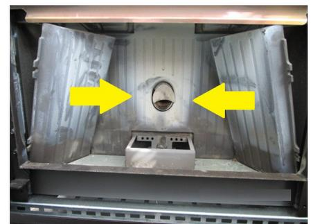
**Fig. 110 - Extracción de las paredes laterales de hierro fundido**
