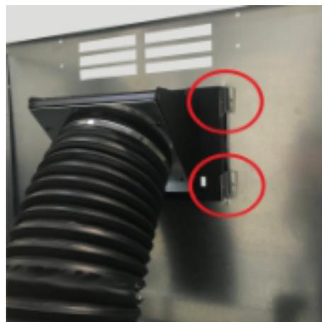
**Fig. 70 - Fijación del interior de la trampilla**
