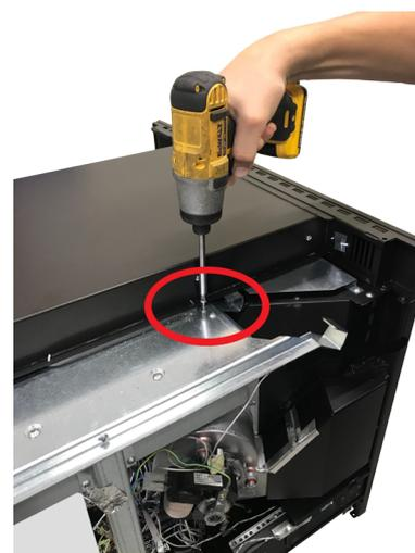
**Fig. 57 - Fijación central del cajón**
