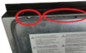
Fig. 31 - Junta deteriorada
