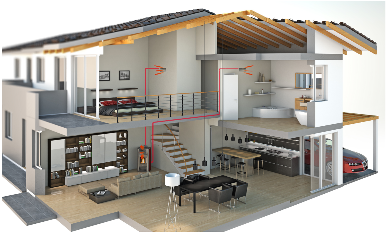
Fig. 50 - Beispiel einer Kanalisierung
