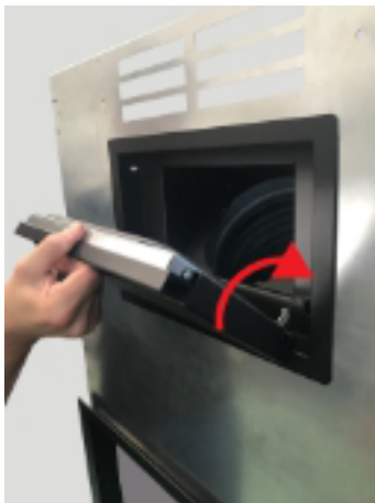
Fig. 72 - Tür in die Ladeklappe fügen
