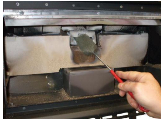
Fig. 49 - Reinigung mit Flaschenbürste
