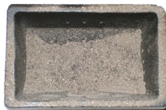
Fig. 45 - Beispiel für eine schmutzige Brennschale
