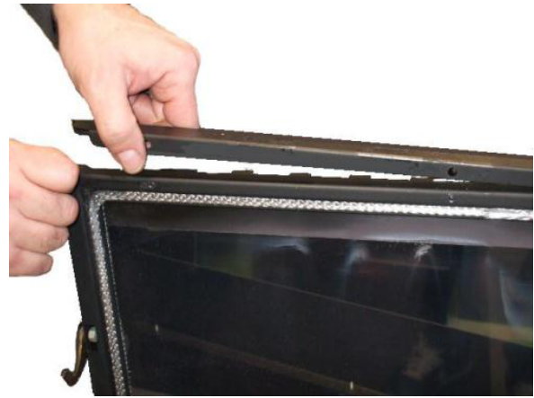
Fig. 117 - Door profiles removal
