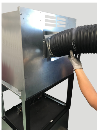
Fig. 67 - Plaatsing flexibele buis
