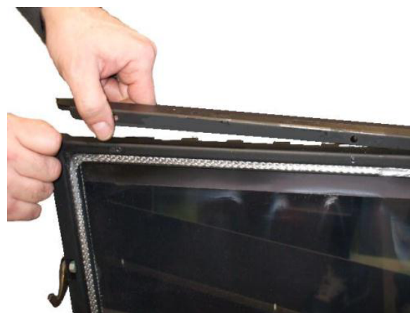
Fig. 117 - Rimozione profili porta
