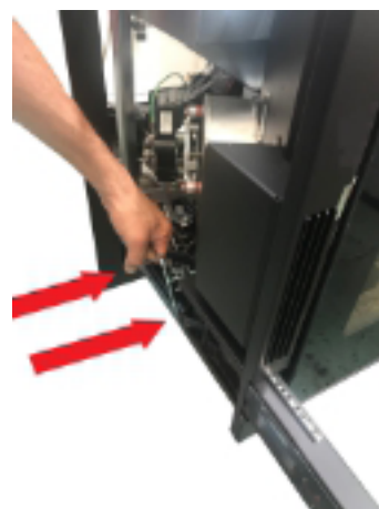
Fig. 24 - Rimozione corpo macchina
