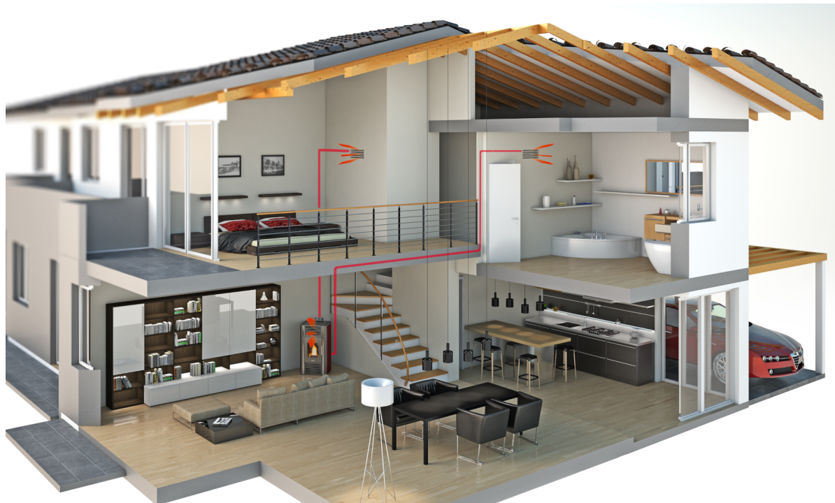
Fig. 50 - Esempio di canalizzazione
