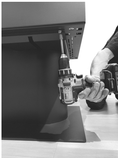
Fig. 16 - Fastgøring af sokkel
