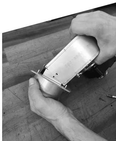
Fig. 30 - Fastgør flange og samling til ventilatoren
