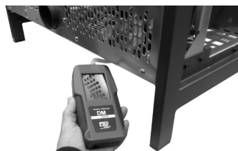
Fig. 50 - Ramme digital trykafbrydertilslutning FRAME
