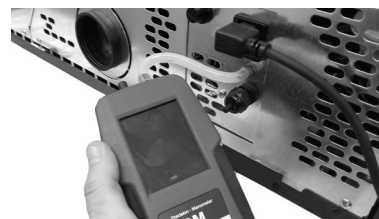
Fig. 51 - Ramme digital trykafbrydertilslutning Modo e Quasimodo Up
