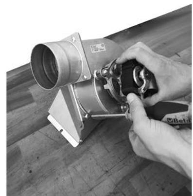
**Fig. 36 - Fije con tornillos**
