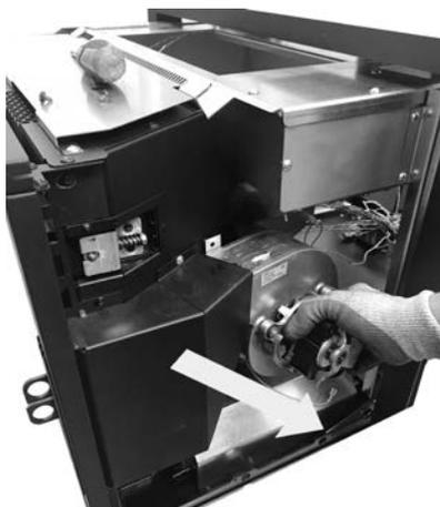
**Fig. 62 - Extraiga el ventilador**
