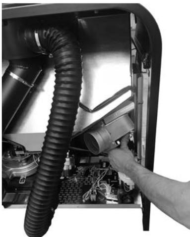
*Fig. 37 - Fije el cárter y el ventilador a la estufa*
