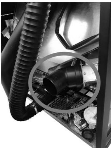
*Fig. 38 - Coloque el racor de 45°*
