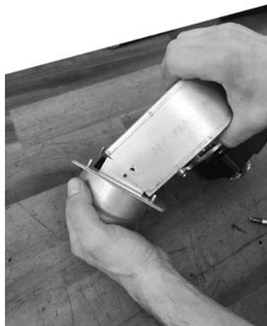
**Fig. 32 - Fija la abrazadera + racor del ventilador**
