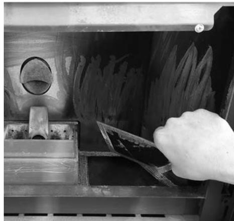
**Fig. 69 - Retire la tapa de inspección**
