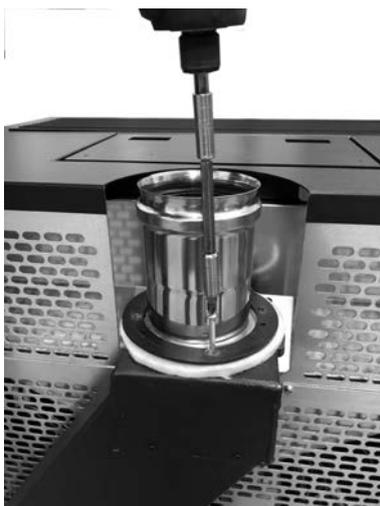
*Fig. 41 - Desenroscar la descarga*
