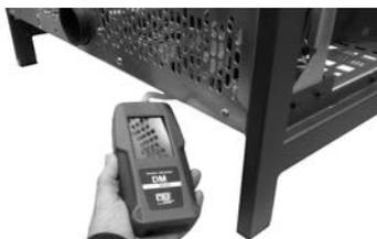
Fig. 52 - Conexión del presostato digital Frame<sup>2</sup>
