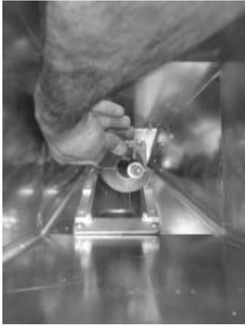
**Fig. 57 - Extracción de la espiral**
