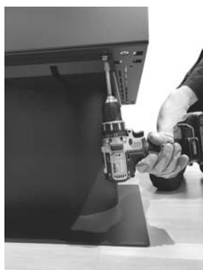
Fig. 18 - Fijación del pedestal
