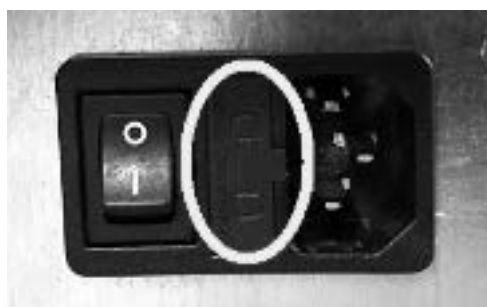
Fig. 73 - Abdeckklappe mit Sicherungen, die ausgewechselt werden müssen
