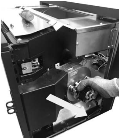
Fig. 60 - Remove the fan
