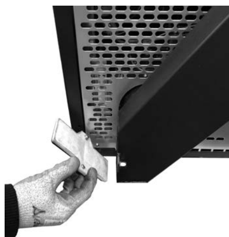
Fig. 65 - Pulizia canale da fumo
