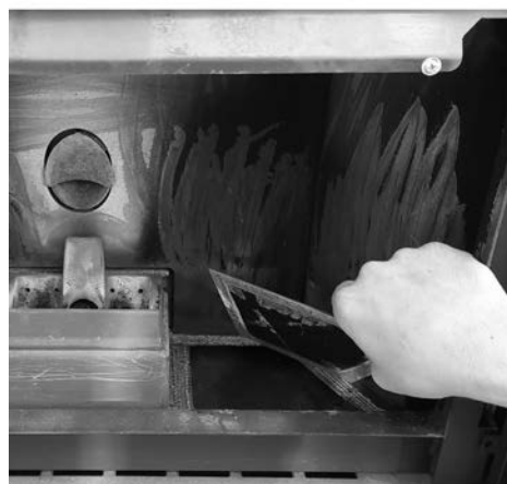
Fig. 67 - Rimuovere tappo ispezione
