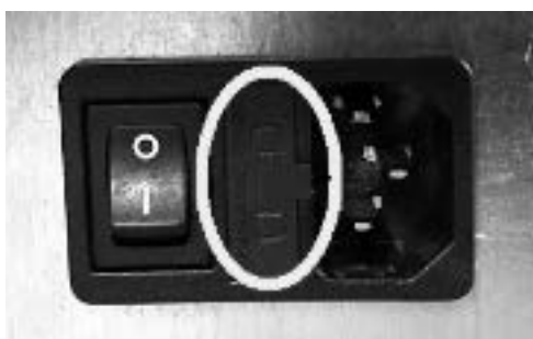
Fig. 73 - Sportellino con i fusibili da rimuovere
