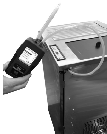
Fig. 28 - Conexión del presostato digital
