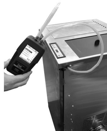
Fig. 26 - Anschluss des Digitaldruckwächters
