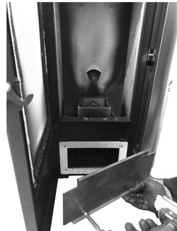
Fig. 29 - Den Inspektionsstopfen entfernen
