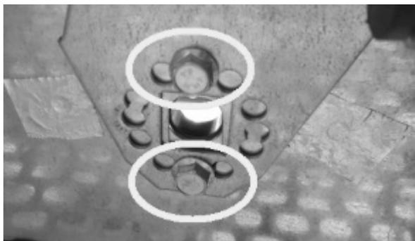
*Fig. 34 - Die Schrauben entfernen*
