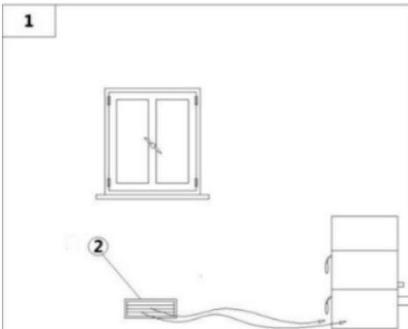
Fig. 7 - Direkte Luftzufuhr
