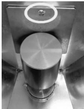
*Fig. 35 - Entfernen der Schraube*
