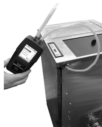
Fig. 29 - Connexion du pressostat numérique
