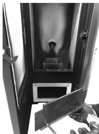
Fig. 32 - Retirer le bouchon d'inspection
