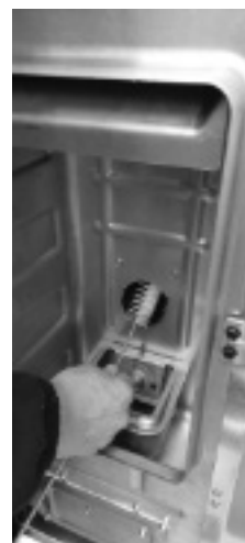
Fig. 40 - Nettoyage avec nettoie-pipes
