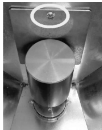
Fig. 79 - Retirada del tornillo
