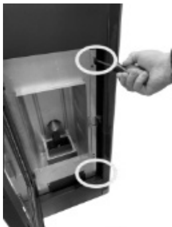
Fig. 43 - Retire los tornillos
