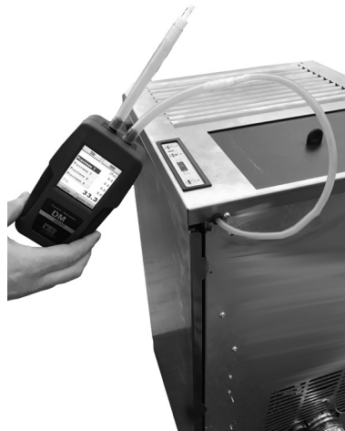
Fig. 64 - Conexión del presostato digital
