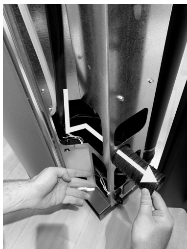
Fig. 56 - Paso del tubo flexible 1
