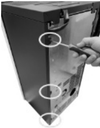
Fig. 31 - Retire los tornillos
