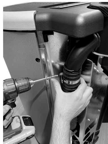
Fig. 55 - Retirar el tubo flexible
