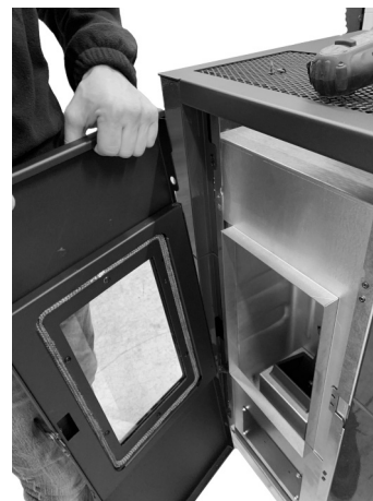
Fig. 25 - Remove the door
