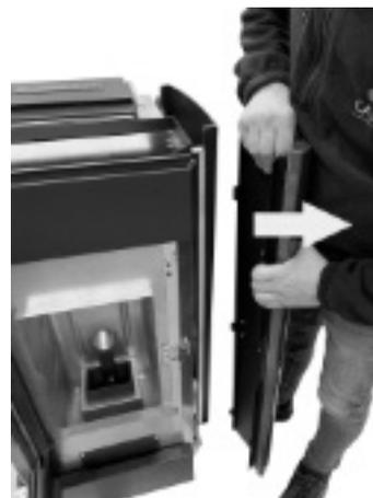
*Fig. 44 - Das Profil entfernen*
