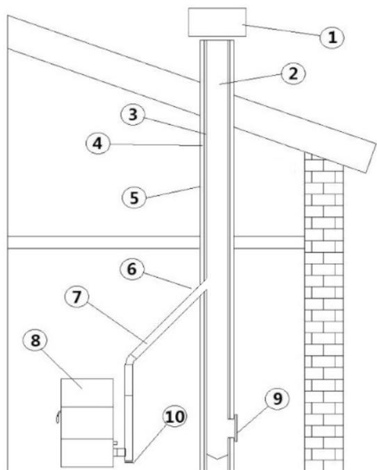
Fig. 2 - Bauteile Kamin
