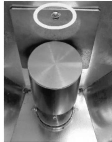
Fig. 79 - Entfernen der Schraube
