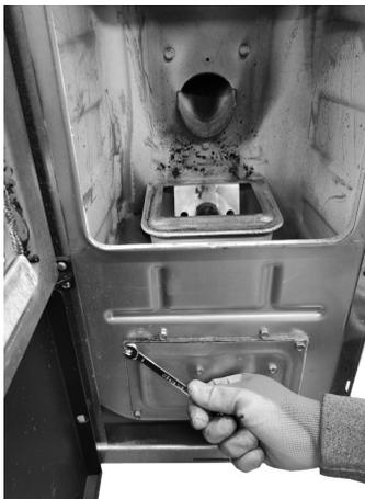
**Fig. 70 - Die Schrauben entfernen**
