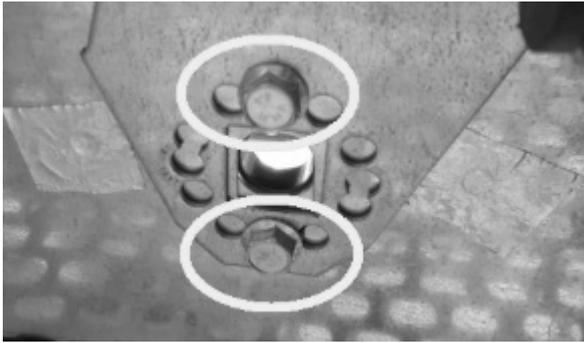
Fig. 78 - Die Schrauben entfernen
