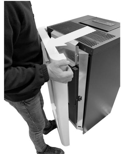
Fig. 30 - Entfernen des Rahmens
