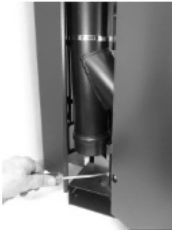
**Fig. 68 - Den Deckelhalter lösen**
