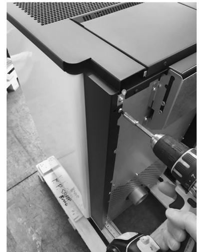
Fig. 39 - Die vollständige Seitenwand befestigen
