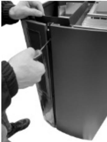
*Fig. 40 - Die Schrauben entfernen*
