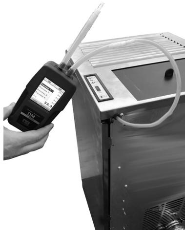
Fig. 64 - Anschluss des Digitaldruckwächters
