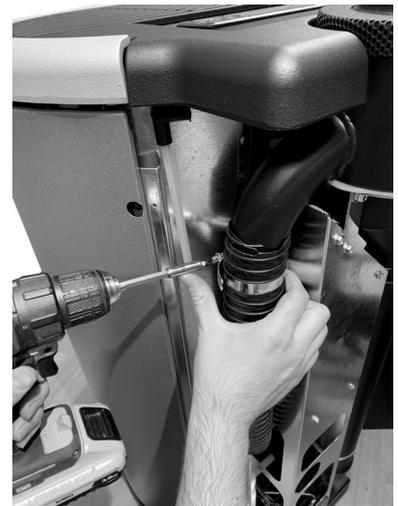
Fig. 55 - Schlauch herausziehen
