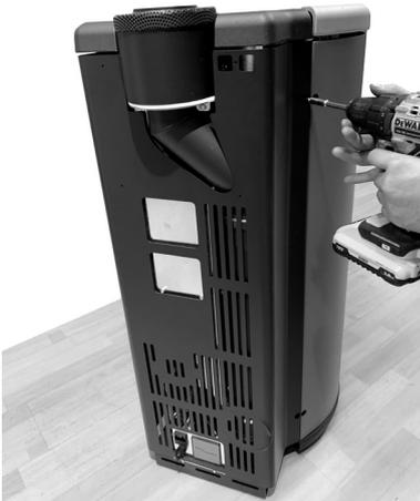
Fig. 53 - Gehäuse abnehmen
