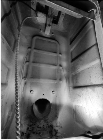
*Fig. 74 - Mit einer Rohrreinigungsbürste reinigen*
