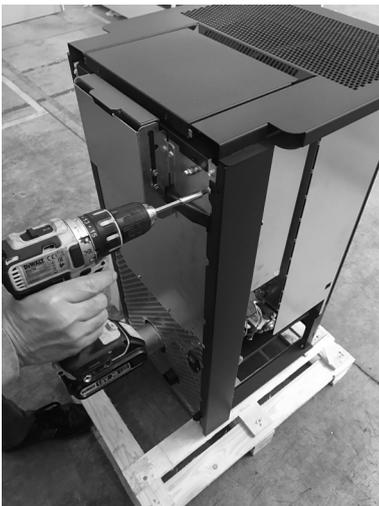
Fig. 37 - Das schwarze Profil entfernen
