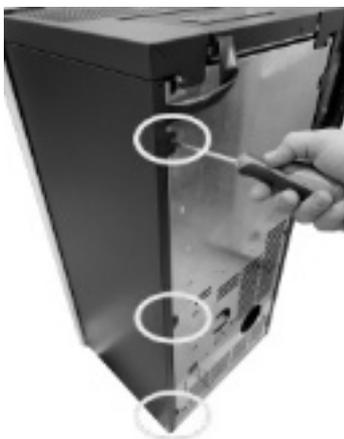
Fig. 31 - Die Schrauben entfernen
