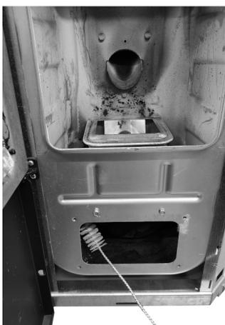
**Fig. 72 - Mit einer Rohrreinigungsbürste reinigen**
