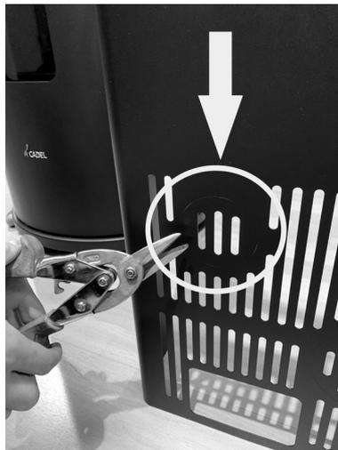
Fig. 54 - Ring zerschneiden
