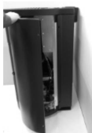
*Fig. 47 - Die Seitenwände aushaken*
