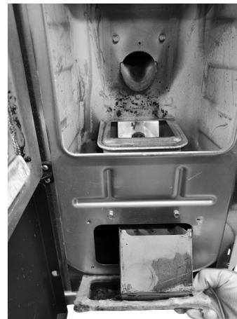
**Fig. 71 - Den Inspektionsstopfen entfernen**
