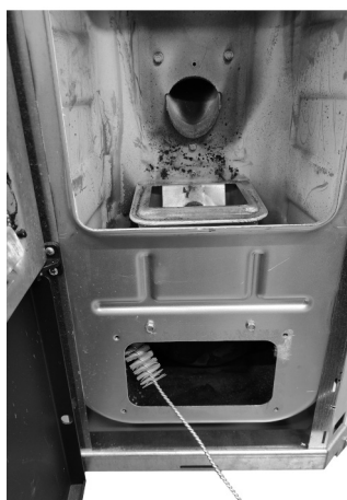
Fig. 72 - Reinig met pijpenwisser
