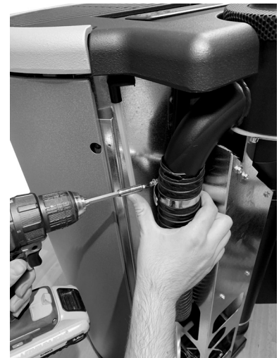
Fig. 55 - Flexibele buis naar buiten trekken
