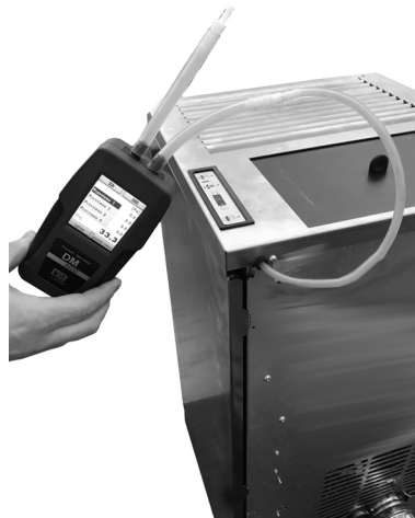
Fig. 64 - Aansluiting digitale drukregelaar
