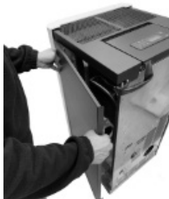
Fig. 32 - De zijpanelen losmaken
