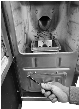
Fig. 70 - Verwijder de schroeven
