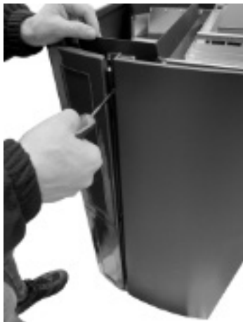
Fig. 40 - De schroeven verwijderen
