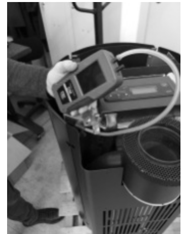
Fig. 65 - Aansluiting digitale drukregelaar
