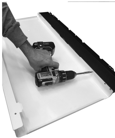
Fig. 38 - Bevestig het gekleurde zijpaneel
