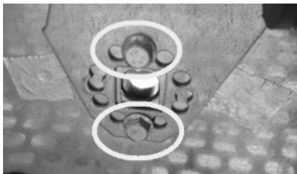
Fig. 78 - Verwijder de schroeven
