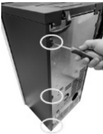
Fig. 31 - De schroeven verwijderen
