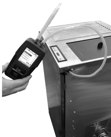
Fig. 75 - Connexion du pressostat numérique
