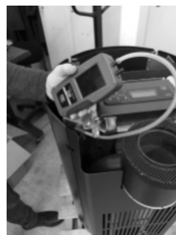
Fig. 76 - Connexion du pressostat numérique
