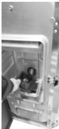
*Fig. 33 - Rimozione braciere*
