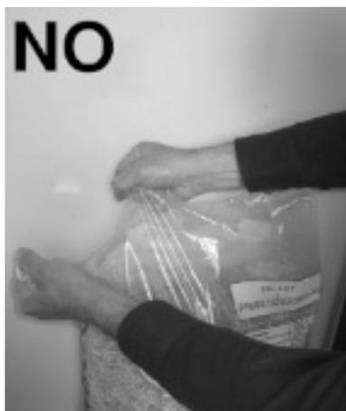
Fig. 24 - Apertura errata del sacco di pellet
