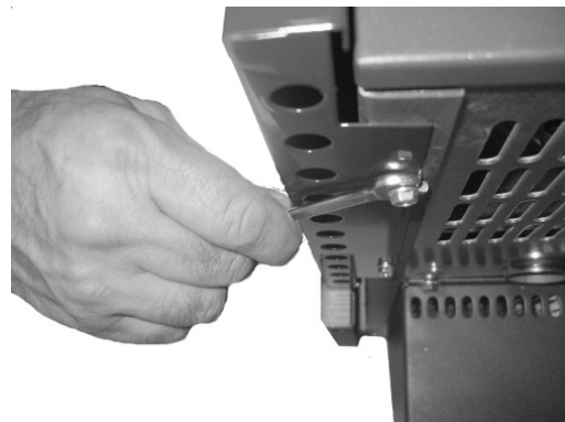
Fig. 29 - Fijación de los paneles
