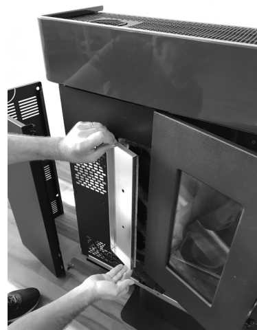
Fig. 59 - Desmontaje del panel de inspección
