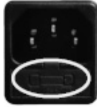
Fig. 63 - Ventanilla con los fusibles de remover
