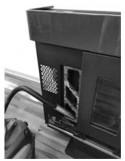
Fig. 58 - Reinigung Rauchgaskammer
