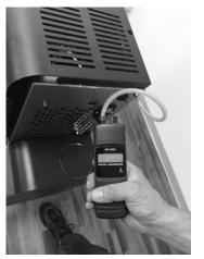
Fig. 46 - Anschluss des Digitaldruckwächters
