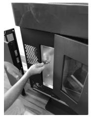
Fig. 55 - Das Wärmeschildpaneel entfernen
