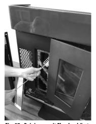
Fig. 57 - Reinigung mit Flaschenbürste
