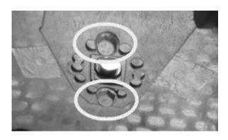
Fig. 61 - Die Schrauben entfernen
