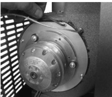
Fig. 53 - Fume fan cleaning: phase1
