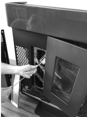
Fig. 58 - Reiniging met flessenwisser
