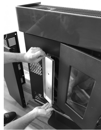
Fig. 57 - Verwijdering van het inspectiepaneel
