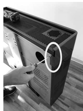
Fig. 32 - Zet de schroeven vast
