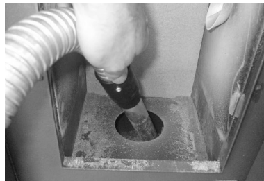
Fig. 39 - Reiniging ruimte vuurpot
