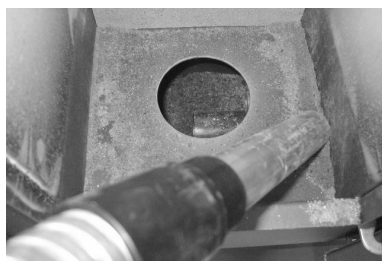
Fig. 38 - Reiniging ruimte aslade
