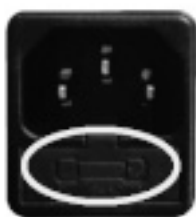
Fig. 70 - Hublot avec les fusibles à enlever
