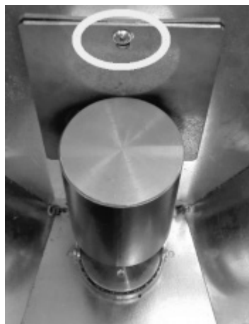
Fig. 72 - Retrait des vis
