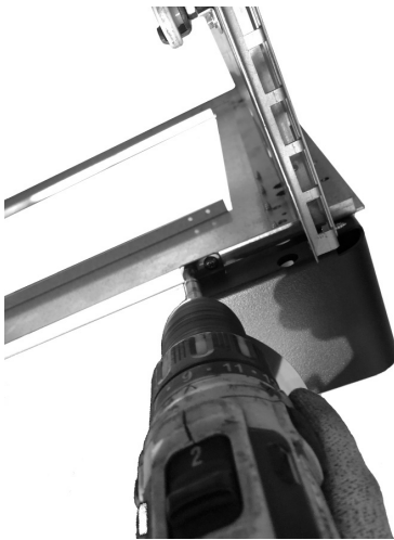
Fig. 41 - Montage der FüÙe 1
