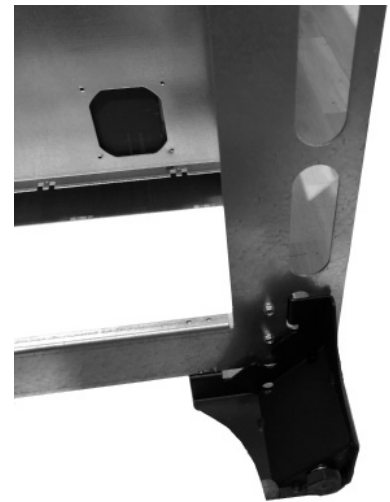
Fig. 43 - Montage der FüÙe 3
