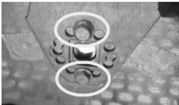
Fig. 50 - Verwijder de schroeven
