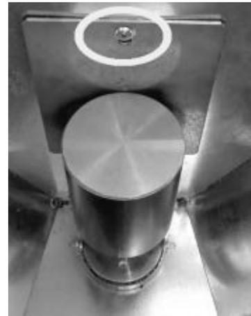
*Fig. 53 - Retirada del tornillo*
