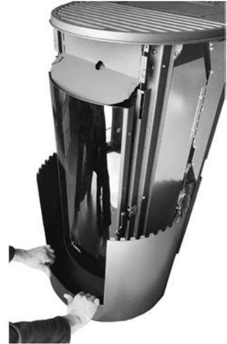
Fig. 28 - Saque la cobertura inferior tirando hacia usted.
