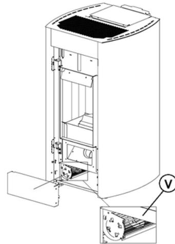
**Fig. 43 - Ventilatoren**
