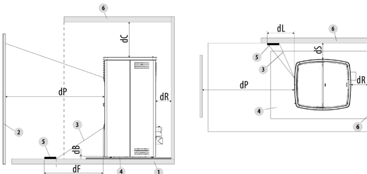
**Fig. 15 - Sicherheitsabstand vom Brennstoff**
