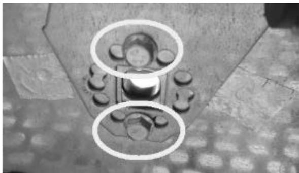
*Fig. 50 - Die Schrauben entfernen*
