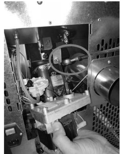
**Fig. 46 - Getriebemotor entfernen**
