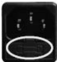
*Fig. 49 - Abdeckklappe mit Sicherungen, die ausgewechselt werden müssen*
