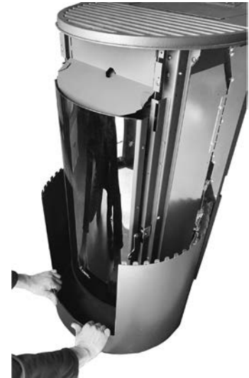
Fig. 35 - Extraire la coque inférieure en tirant vers soi.
