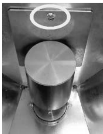
Fig. 60 - Retrait des vis
