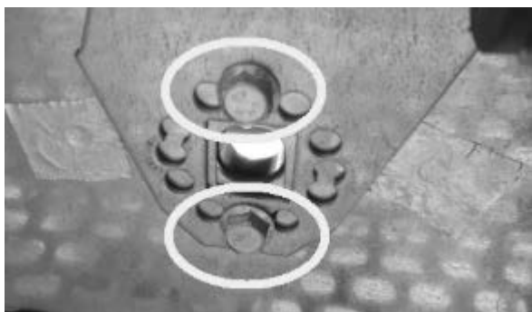
Fig. 59 - Retirer les vis
