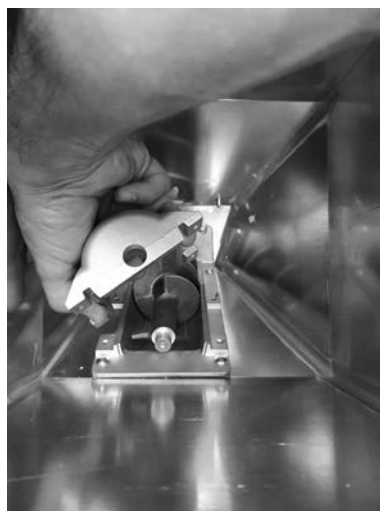
Fig. 54 - Retrait de la coque
