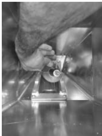
Fig. 56 - Retrait des spirales
