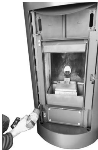
Fig. 22 - Rimozione viti profili (dx e sx).
