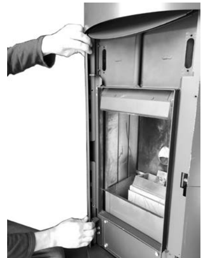
Fig. 23 - Rimozione profili anteriori (dx e sx).
