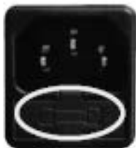
Fig. 49 - Sportellino con i fusibili da rimuovere
