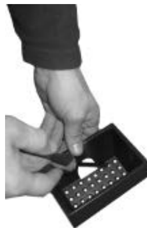
Fig. 33 - het schoonmaken van de vuurpot
