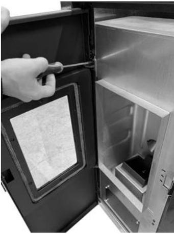
Fig. 24 - Extracción de los tornillos
