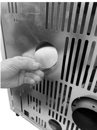
**Fig. 51 - Extracción del anillo**
