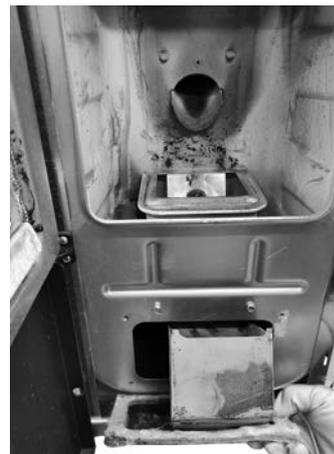
*Fig. 77 - Retire la tapa de inspección*
