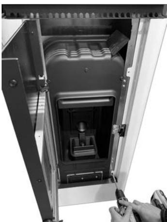
**Fig. 35 - Extracción de los tornillos delanteros**
