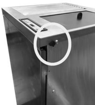
Fig. 73 - Extracción del tapón
