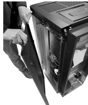
**Fig. 34 - Extracción de la pared lateral**
