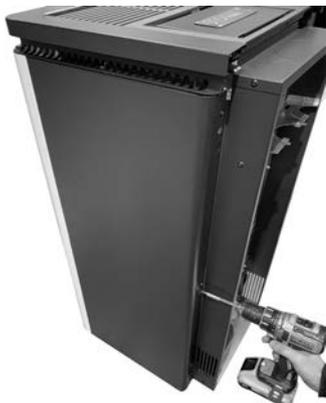
**Fig. 33 - Extracción de los tornillos traseros**
