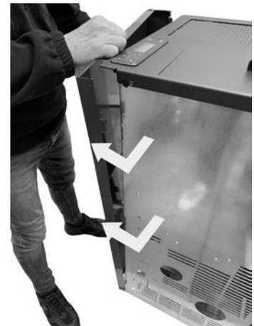
Fig. 29 - Extracción las paredes laterales
