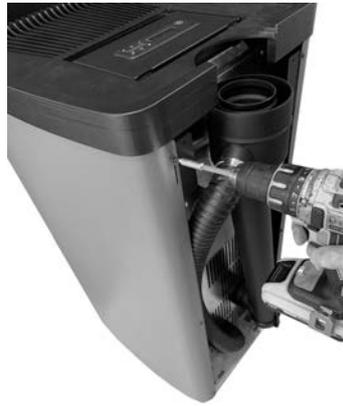
**Fig. 31 - Extracción de los tornillos traseros**
