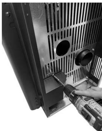
Fig. 57 - Extracción del desviador
