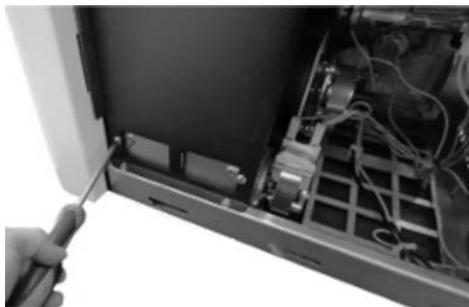
Fig. 82 - Limpieza ventilador ambiente (Atena<sup>3</sup> Plus 12/14 - Duke 12/14 At - Saba 12/14)
