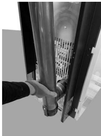
**Fig. 43 - Acoplamiento del tubo d. 80 mm**
