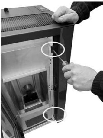
Fig. 27 - Extracción los tornillos
