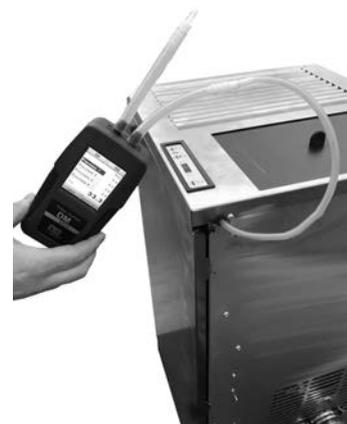
Fig. 74 - Conexión del presostato digital
