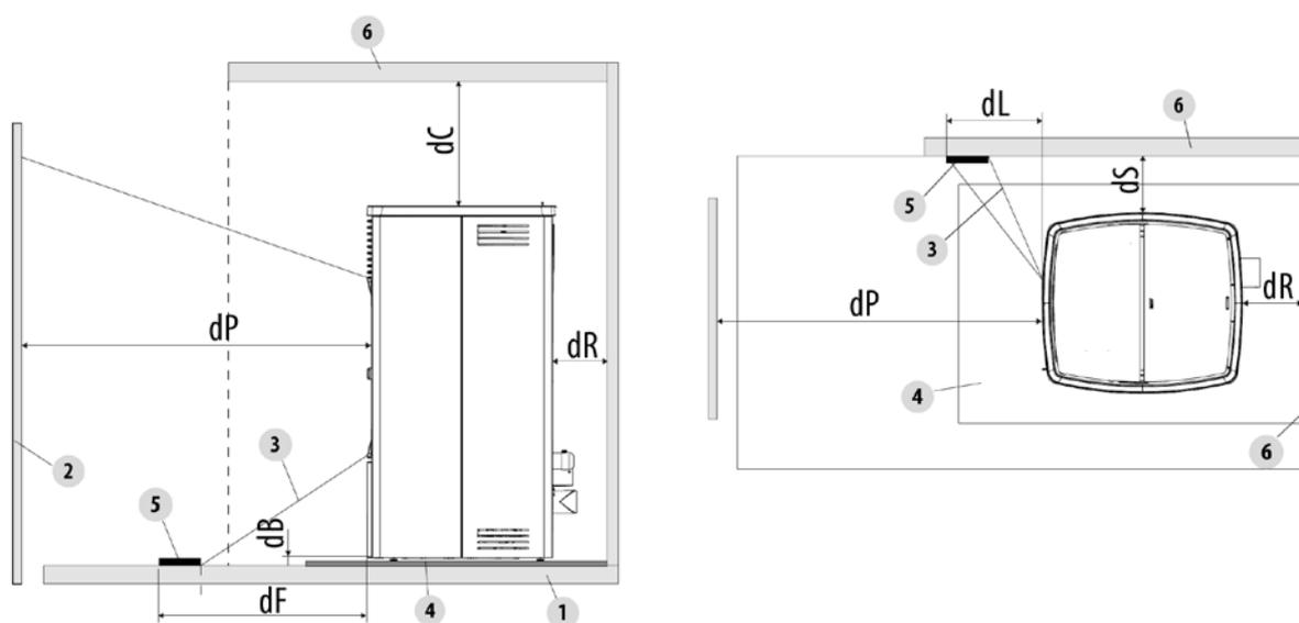
Fig. 14 - Distanze di sicurezza da materiale combustibile
