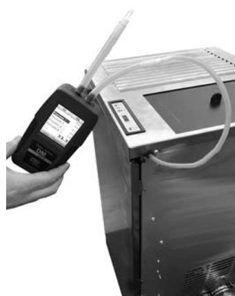
Fig. 72 - Collegamento pressostato digitale
