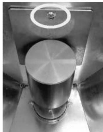
*Fig. 84 - Rimozione vite*
