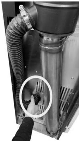
**Fig. 50 - Inserire tubo flessibile**
