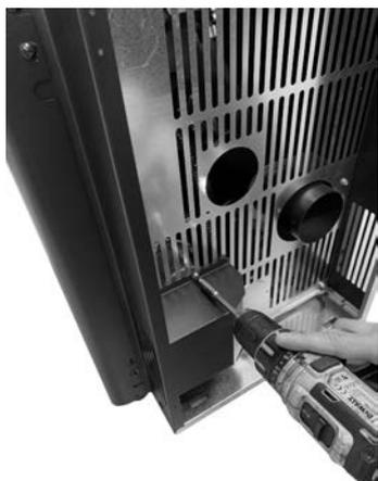
**Fig. 55 - Rimozione deviatore**
