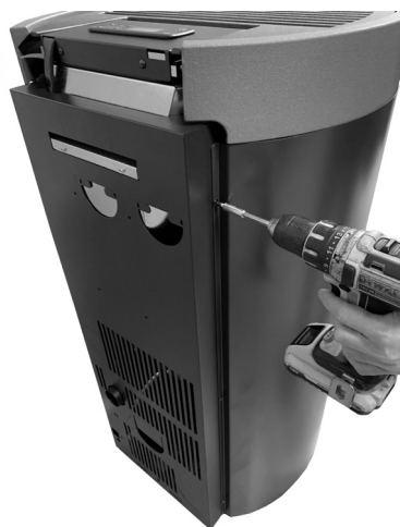
Fig. 27 - Achterste schroeven verwijderen
