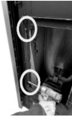
Fig. 84 - Verwijder de zeskantschroeven
