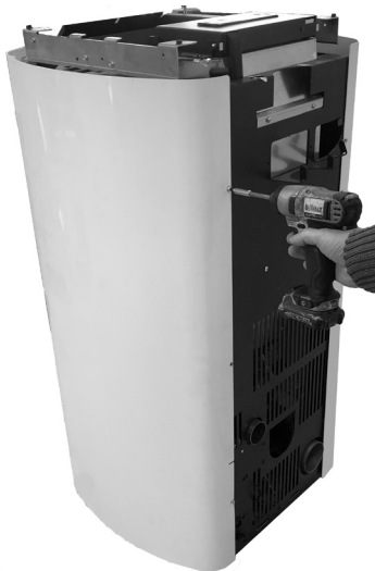
Fig. 42 - Achterste schroeven verwijderen
