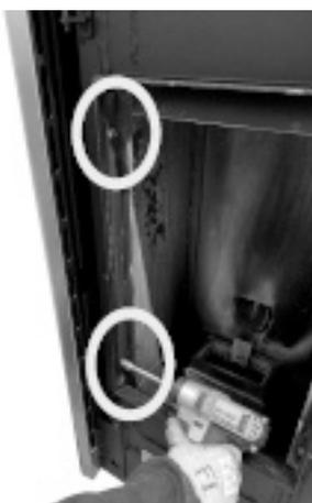
**Fig. 74 - Extraiga los tornillos hexagonales**
