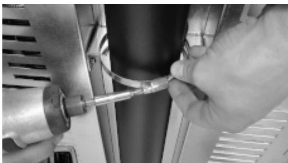
*Fig. 48 - Bloqueo con la abrazadera*
