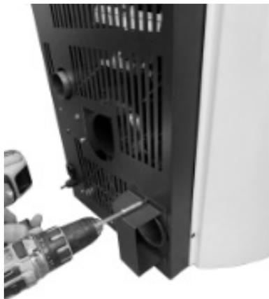
**Fig. 53 - Extracción del desviador**
