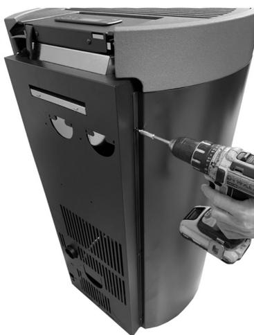
Fig. 22 - Extracción de los tornillos traseros
