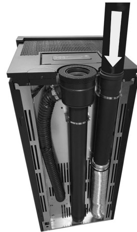
Fig. 65 - Raccorder le tuyau
