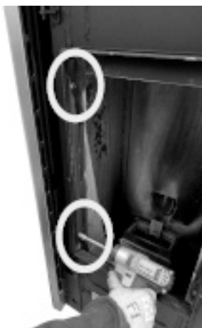
Fig. 79 - Ôter les vis hexagonales
