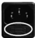
Fig. 92 - Hublot avec les fusibles à enlever
