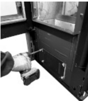
Fig. 86 - Retirer le bouchon
