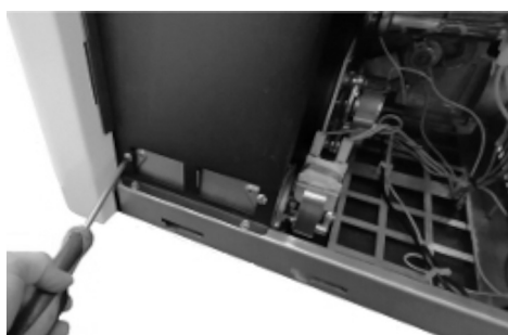
Fig. 90 - Nettoyage de le ventilateur ambiant
