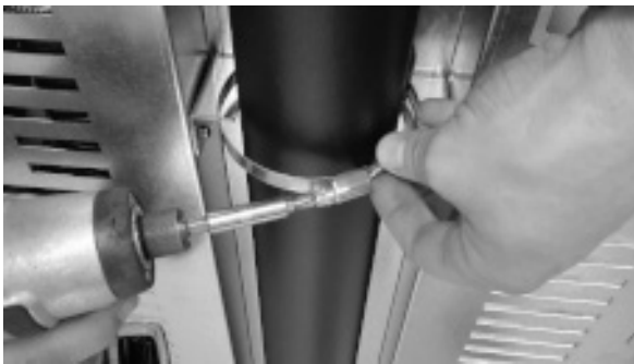
Fig. 53 - Bloquer avec un collier de serrage
