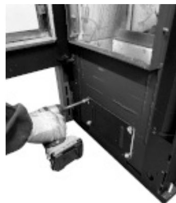
Fig. 75 - Retirer le bouchon
