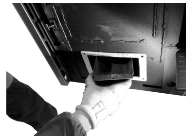
Fig. 42 - Rimuovere il deviatore fumi
