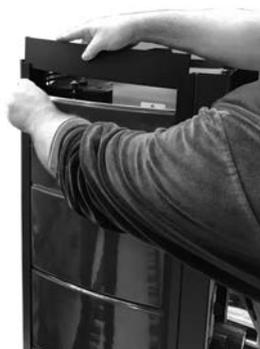
*Fig. 44 - Coloque el compensador*
