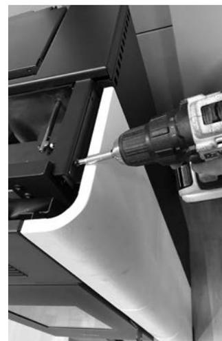
*Fig. 27 - Fijación al panel*
