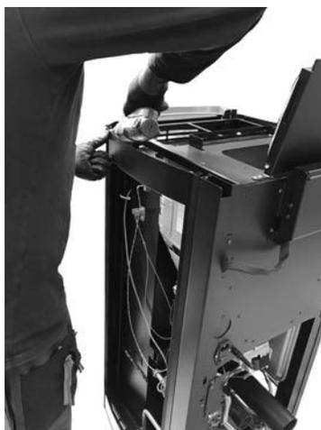
*Fig. 41 - Extracción del compensador*
