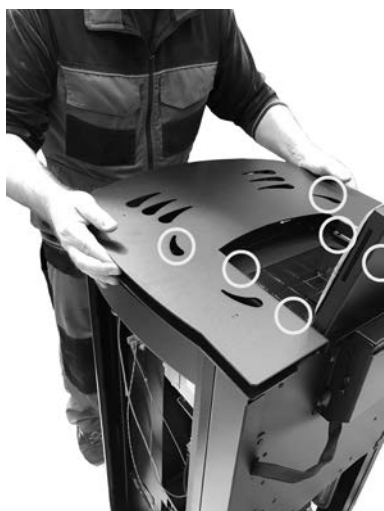
Fig. 40 - Verwijdering van de afdekking
