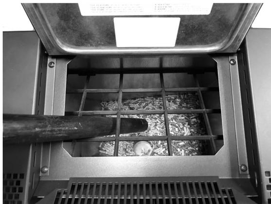
Fig. 32 - Reinigung Tank und Schnecke
