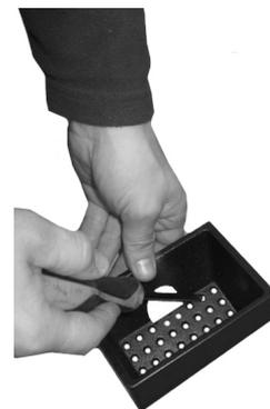
**Fig. 29 - Reinigung Brennschale**
