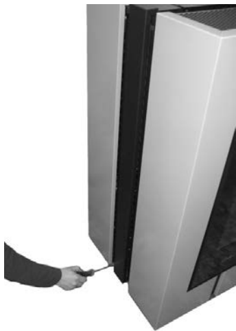
Fig. 85 - Extracción tornillos inferiores
