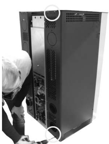
Fig. 101 - Extracción de los tornillos posteriores
