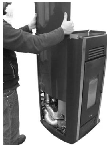
Fig. 99 - Desmontaje de los laterales
