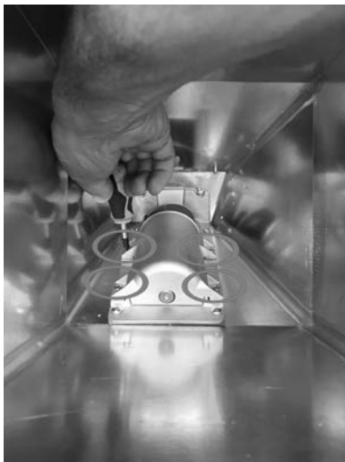
Fig. 77 - Extracción de los tornillos
