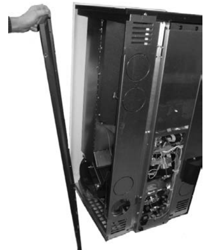
Fig. 84 - Desmontaje de la pared lateral
