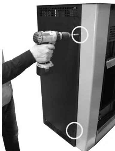
Fig. 100 - Extracción de los tornillos laterales
