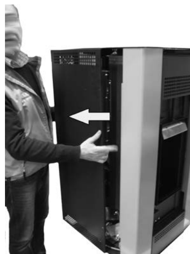
Fig. 102 - Desmontaje de los laterales
