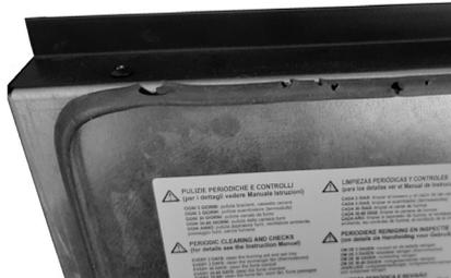
Fig. 23 - Junta deteriorada
