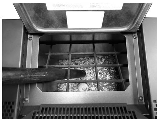
Fig. 32 - Limpieza depósito y coquea
