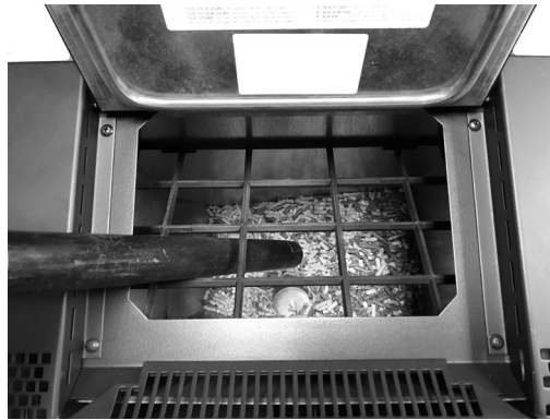
Fig. 32 - Reiniging van de voorraadbak en transportschroef
