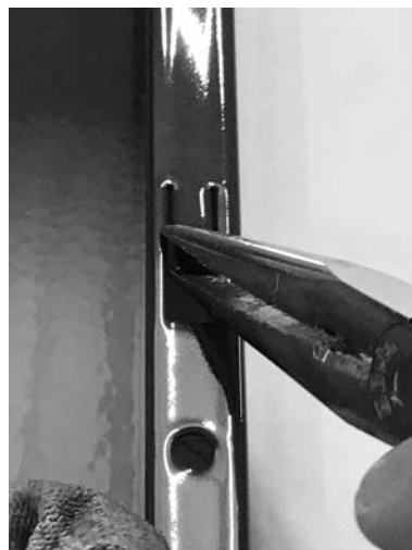
Fig. 45 - Biegen der kleinen Zungen nach außen
