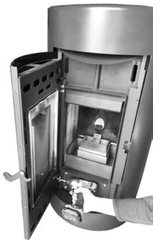
Fig. 63 - Ausbau der Tür
