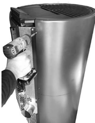
Fig. 66 - Die hinteren Schrauben entfernen.
