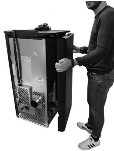
Fig. 48 - Abnehmen der Seitenwand
