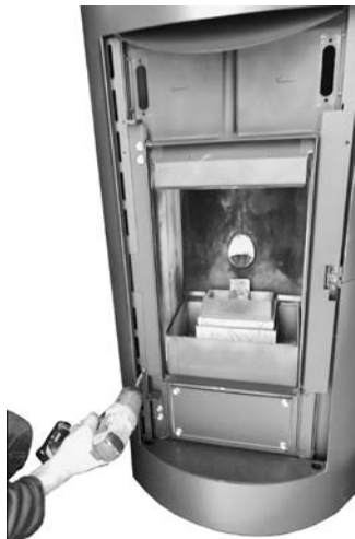
Fig. 65 - Desmontaje de los tornillos de los perfiles (der e izq).
