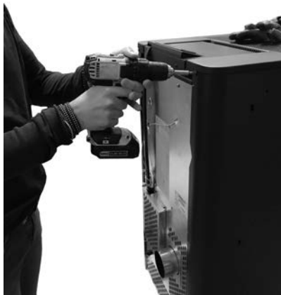
Fig. 48 - Extracción de los tornillos
