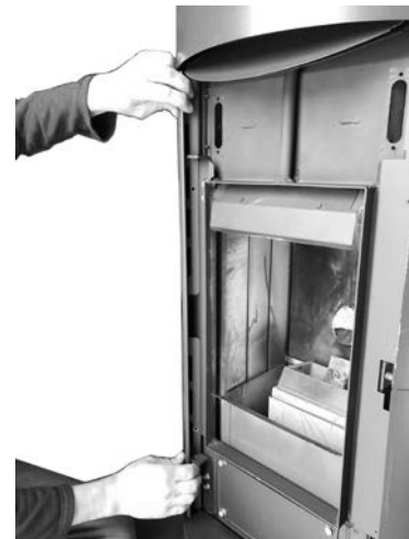
Fig. 66 - Desmontaje de los perfiles anteriores (der e izq).
